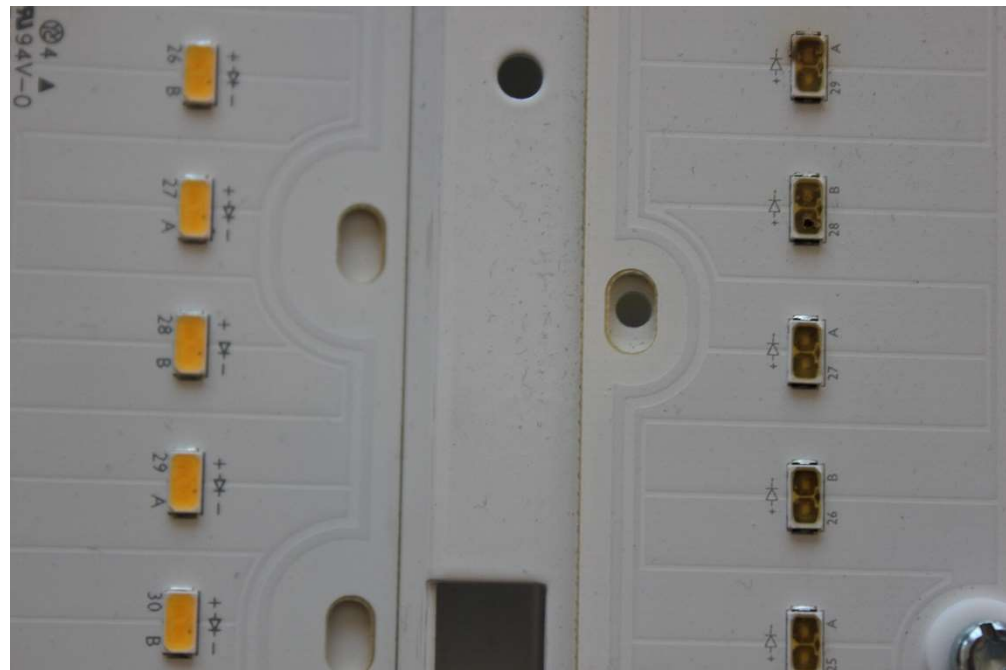
Schädigung durch Schwefelverbindung
